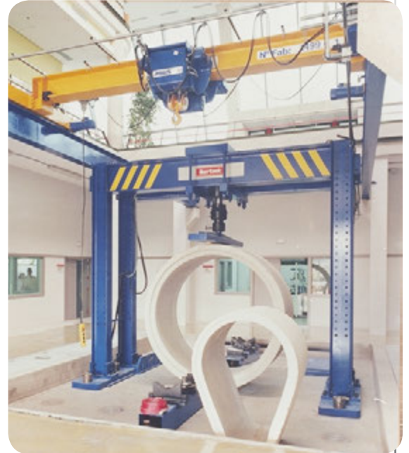
▲ Pórticos para grandes elementos prefabricados Portal type machines for testing large pre-cast specimens
